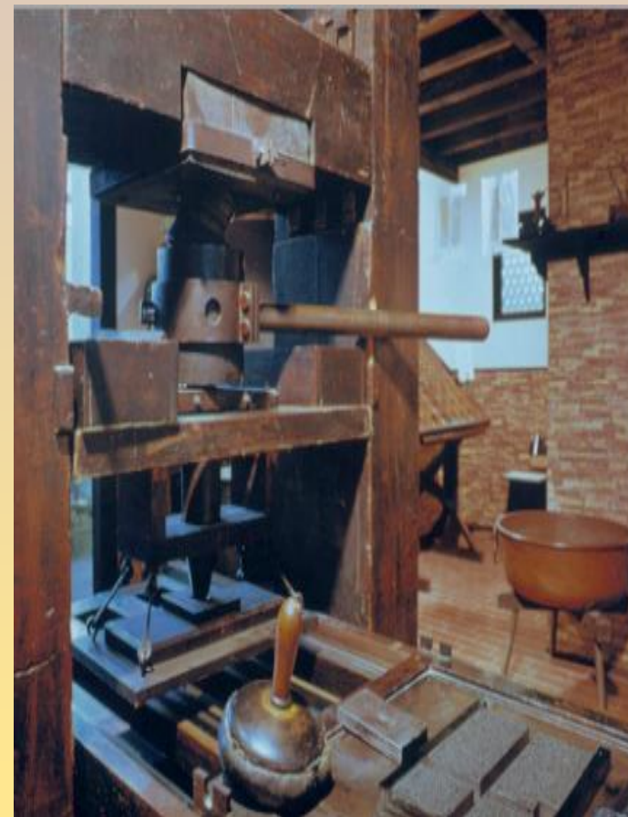
Печатный станок И. Гутенберга с подвижными литерами
